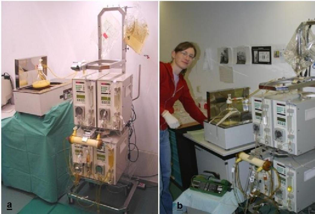
**Abb. 4a:** Herkömmlicher *In-vitro*-Aufbau des SPAD-Systems. Für die aktuelle Aufgabenstellung wurde das Verfahren verfeinert und eine zusätzliche Pumpe für Albumin angebaut, damit sich die Albumin-Standardbikarbonat-Lösung nicht entmischt.
