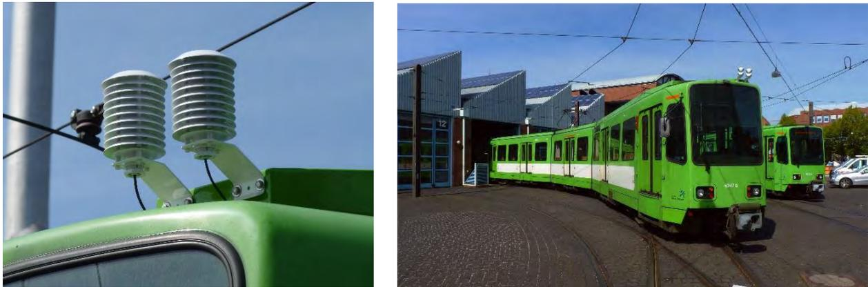
Abb. 8.1: Messsensorik an einer Tram in Hannover.
