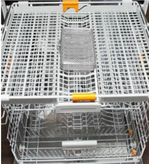
Abbildung 14: Position der Siebschale mit jeweils zehn Prüfkörpern in der Geschirrspülmaschine
