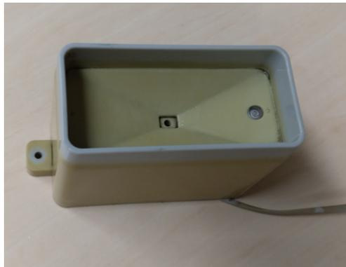
Abbildung 2: Erweiterung des *MESSIs* mit einer kostengünstigen Niederschlagswippe
