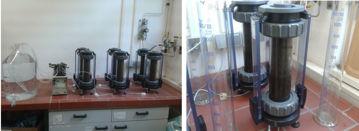
Abbildung 3.10: Aufsättigung der Säulen; rechts: das dunklere Probenmaterial ist bereits aufgesättigt (Quelle: eigene Aufnahmen)
