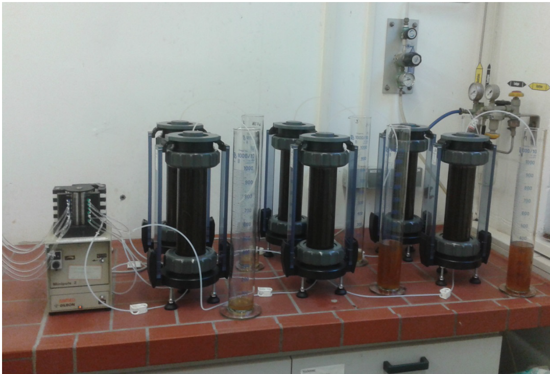
Abbildung 3.11: Säulenperkolationsversuch mit Eluatsammelgefäßen für die 2. Eluatfraktion (Hinweis: für die Fotoaufnahmen wurde die Abdeckung mit Alufolie entfernt; Quelle: eigene Aufnahme)
