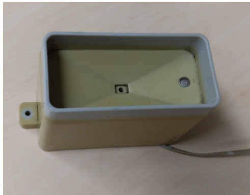
Abbildung 2: Erweiterung des MESSIs mit einer kostengünstigen Niederschlagswippe
