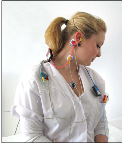
Abbildung 7: Versuchsaufbau zur Messung von cervikal vestibulär evozierter myogener Potenziale
