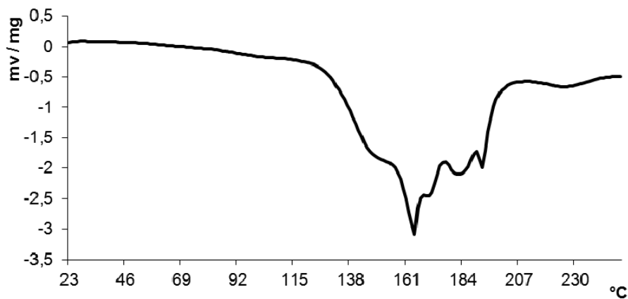
Abbildung 10: DSC-Diagramm von \text{ReCl}_6
