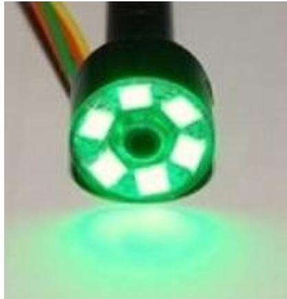
**Abb. 8:** Anordnung der sechs Leuchtdioden der SDF-Kamera, modifiziert nach Kurata et al., 2015
