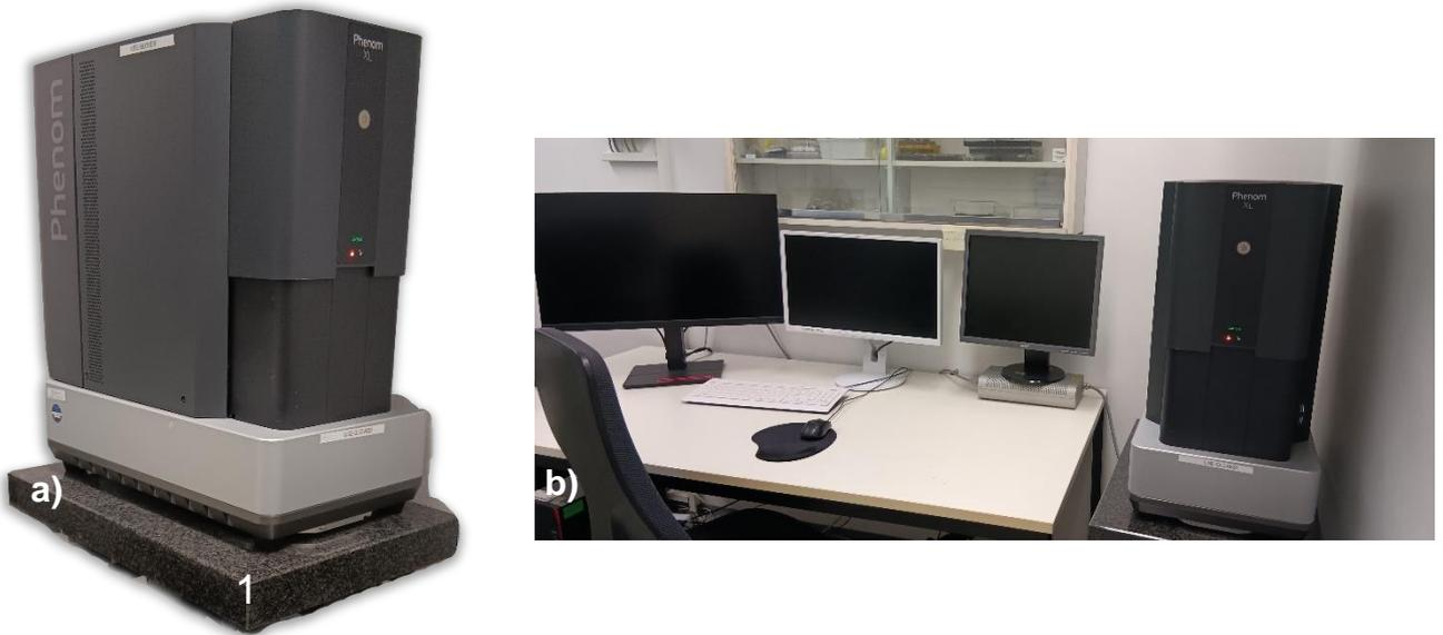
Abbildung 17 a und b: a) Desktop-Rasterelektronenmikroskop Phenom XL (Firma Thermofisher). Das Gerät steht auf einem Schwingungsdämpfungstisch (1), b) Ansicht des Arbeitsplatzes, eigene Aufnahmen mit Kamera.
