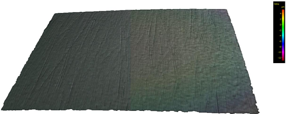
Abbildung 29: repräsentative Aufnahme einer Schmelzoberfläche nach der Politur mit dem Alicona (Fläche 710  $\mu\text{m}$  x 539  $\mu\text{m}$ , 20x Objektiv), halbseitige Darstellung in Echt- und Falschfarben, eigene Aufnahme mit dem Alicona InfiniteFocus.
