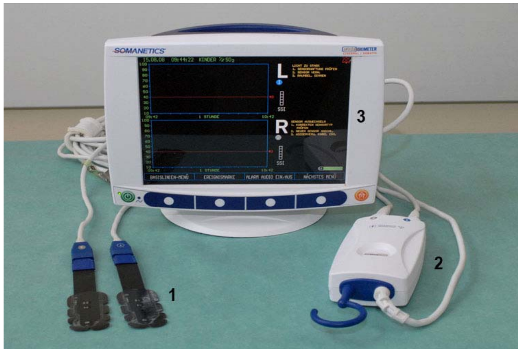
Abb.8: INVOS 5100 bestehend Lichtemitter und Detektoren zusammengefasst in einem festen Klebeband (1), Messeinheit (2) sowie Monitor (3)
