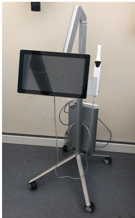
Abb. 6: Verwendeter Intraoralscanner (IOS) Modell TRIOS 4 (3Shape). Die verwendete Ausführung MOVE+ umfasste das rollbare Cart-Gerät für die klinische Praxis, welches aus dem Computer, einem höhenjustierbaren Monitor und der Scanner-Einheit bestand (3Shape A/S, 2022).
