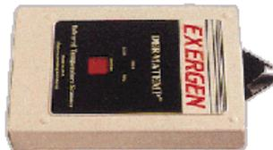
Abbildung 9: Infrarot-Thermometer DermaTemp Model DT-1001-LN
