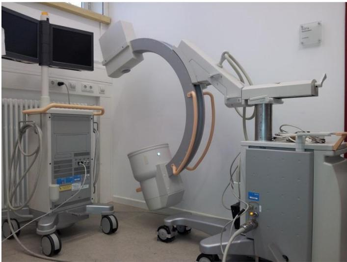
Abbildung 1: C-Bogen für Röntgen- und Durchleuchtungs-aufnahmen
