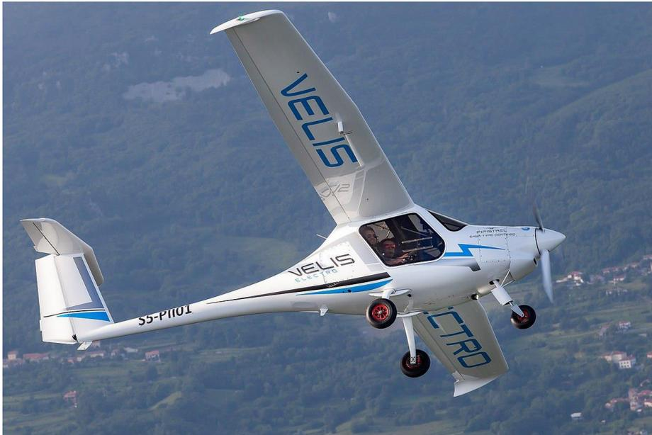
Abbildung UVI5 - Elektroflugzeug Velis Electro von Pipistrel
