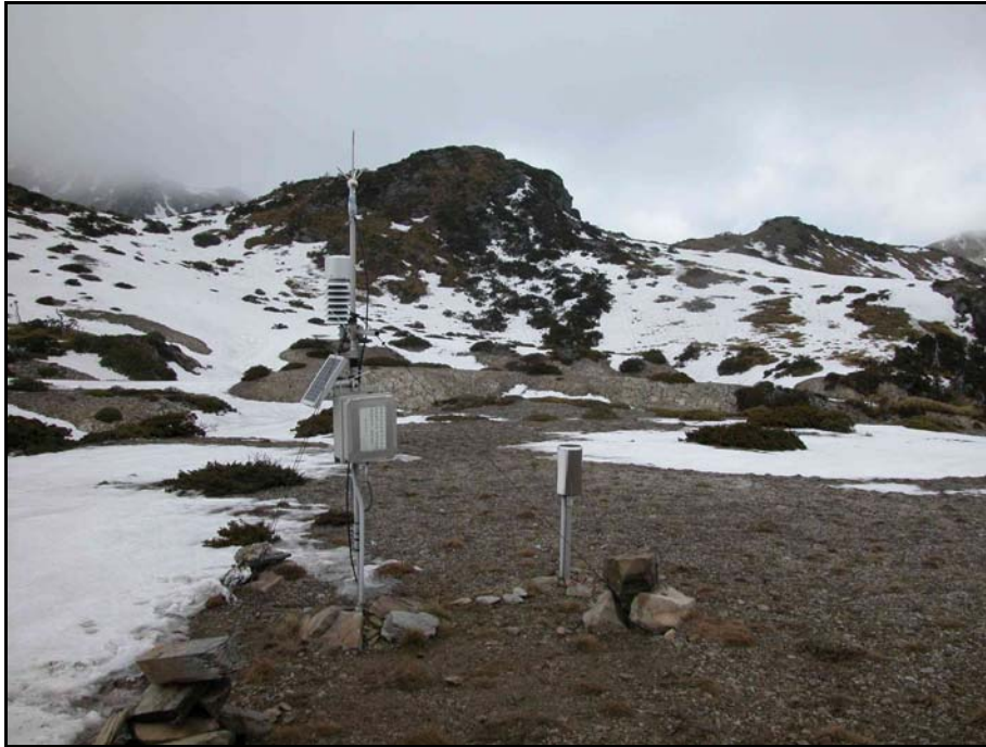
Photo 7 Meteorologische Messstation der Freien Universität Berlin im Nanhuta Shan. Die Station steht auf dem Plateau zwischen dem Nanhu Main Peak und dem East Peak (s. Abb. 4 und 25) auf einer Höhe von 3.560 m. Genaue Position: N 24°21'47.9", E 121°26'48.1". Seit April 2001 werden Lufttemperaturen, Bodentemperaturen in 2, 10 und 20 cm Tiefen sowie Niederschlagsvolumina aufgezeichnet (s. Abb. 24). Die Erhebungen im Hintergrund gehören dem Grat an, der zwischen dem Upper Valley und dem Lower Valley verläuft.
