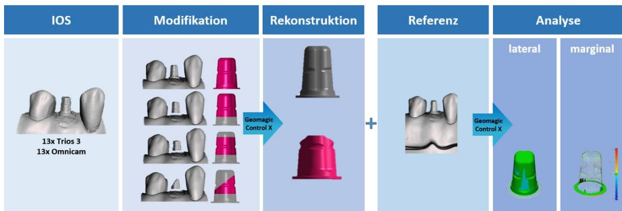
**Abbildung 10:** Schematische Übersicht Methodik Teil II: Genauigkeit nach Implantatrekonstruktion von ZI
