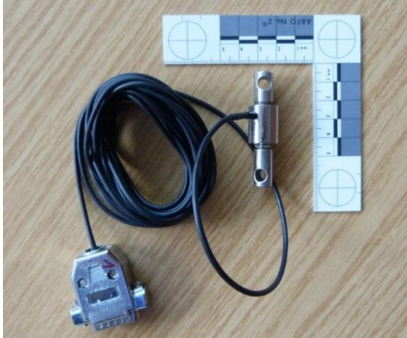
Abb. 9: Newtonmeter, das für die biomechanischen Messungen benutzt wurde
