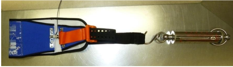
Abb. 12: Mit Newtonmeter und Zugfeder präparierte SAM Sling®
