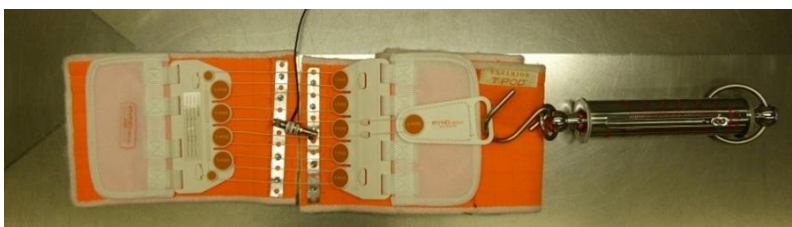
Abb. 11: Mit Newtonmeter und Zugfeder präparierter T-POD ®
