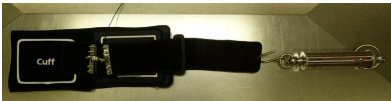
Abb. 10: Mit Newtonmeter und Zugfeder präparierte pneumatische Beckenschlinge VBM ®
