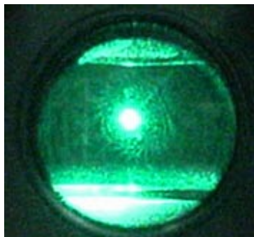
Abbildung 5.11: Blick durch das Mikroskop auf ein Tröpfchen in der Falle im grünen Licht des \text{Ar}^+ -Lasers. Die tatsächliche Größe des Tröpfchens ist kleiner als der helle Punkt in der Bildmitte. Die hellen Bereiche oben und unten im Bild sind die Ringelektroden.
