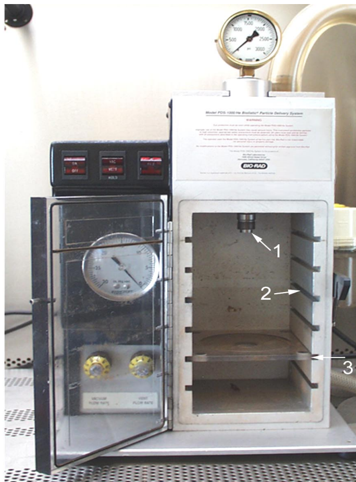
Abbildung 3.1 Foto des PDS1000/He-Systems ohne Einbauteile. 1: Flansch für die Halterung der Berstscheibe. 2: Aussparungen für die Einschübe (insgesamt 6), 3: Halterung für die Petrischalen
