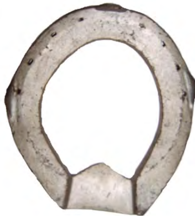
Foto 8: geschlossenes Hufeisen mit ausgeballtem Steg (Huffläche)
