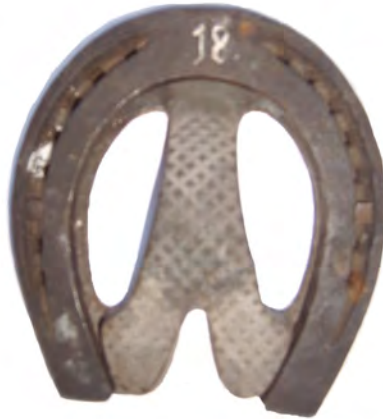
Foto 12: Hufeisen mit Strahlpolster (Bodenfläche)
