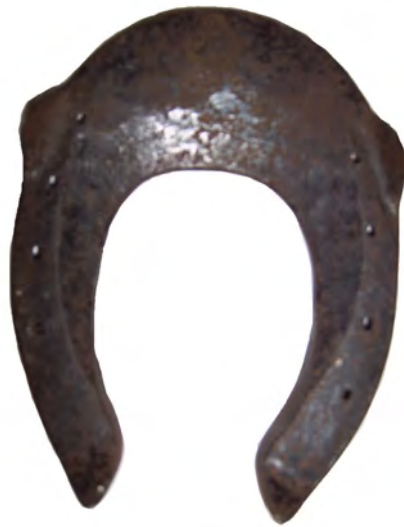
Foto 10: Hufeisen mit breitem Zehenteil und abgedachter Hufsohlenfläche (Hufffläche)
