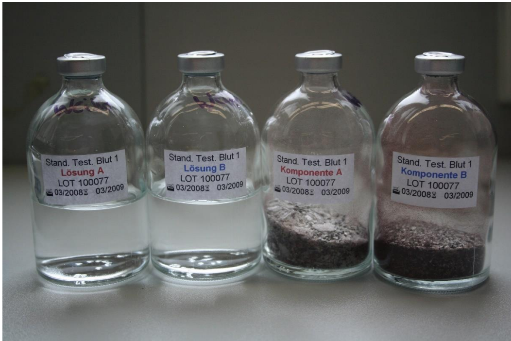
Abbildung 2.2: Testkit zur Herstellung einer standardisierten Testanschmutzung
