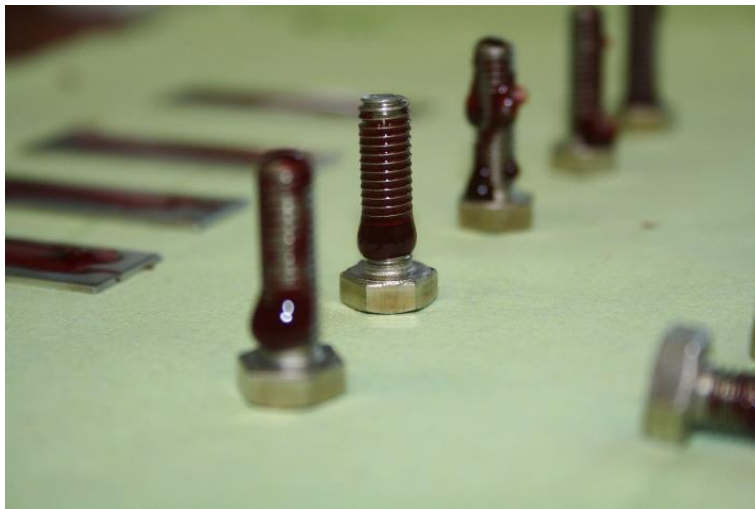
Abbildung 4.1: Ungünstige Verteilung der Testanschmutzung auf den DIN-Schrauben mit Tropfenbildung
