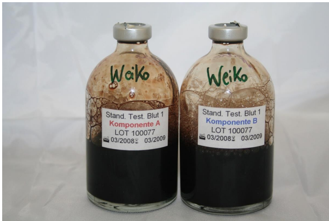
Abbildung 2.3: Komponente A und Komponente B der hergestellten Testanschmutzung
