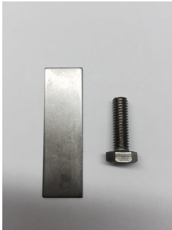
Abbildung 2.1: Edelstahlplättchen und DIN-Schraube als Testkörper
