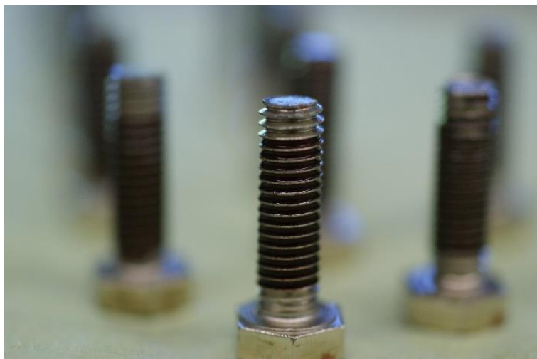
Abbildung 2.5: DIN-Schrauben nach der Kontamination mit der Testanschmutzung zur Trocknung gelagert auf Papierunterlage
