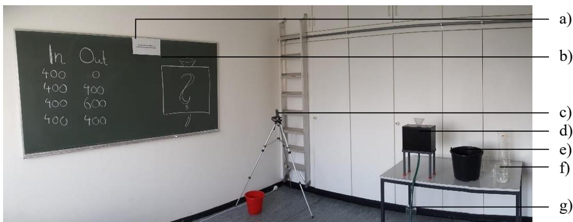
Abbildung 9: Das Blackbox-Setting der vorliegenden Untersuchung. Die Komponenten sind wie folgt beschriftet: a) schriftliche Aufgabe, b) beispielhaft beschriftete Tafel, c) Videokamera (1 von 3), d) Blackbox, e) Eimer mit Wasser, f) verschieden große Bechergläser, g) Messkolben
