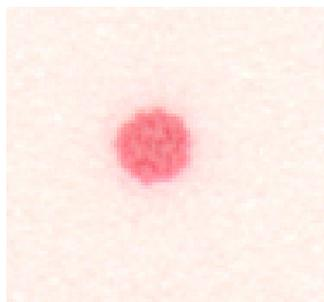
**Abbildung 16: Punktkontakt Durchmesser 5 mm auf Druckmessfolie (stark vergrößert)**
