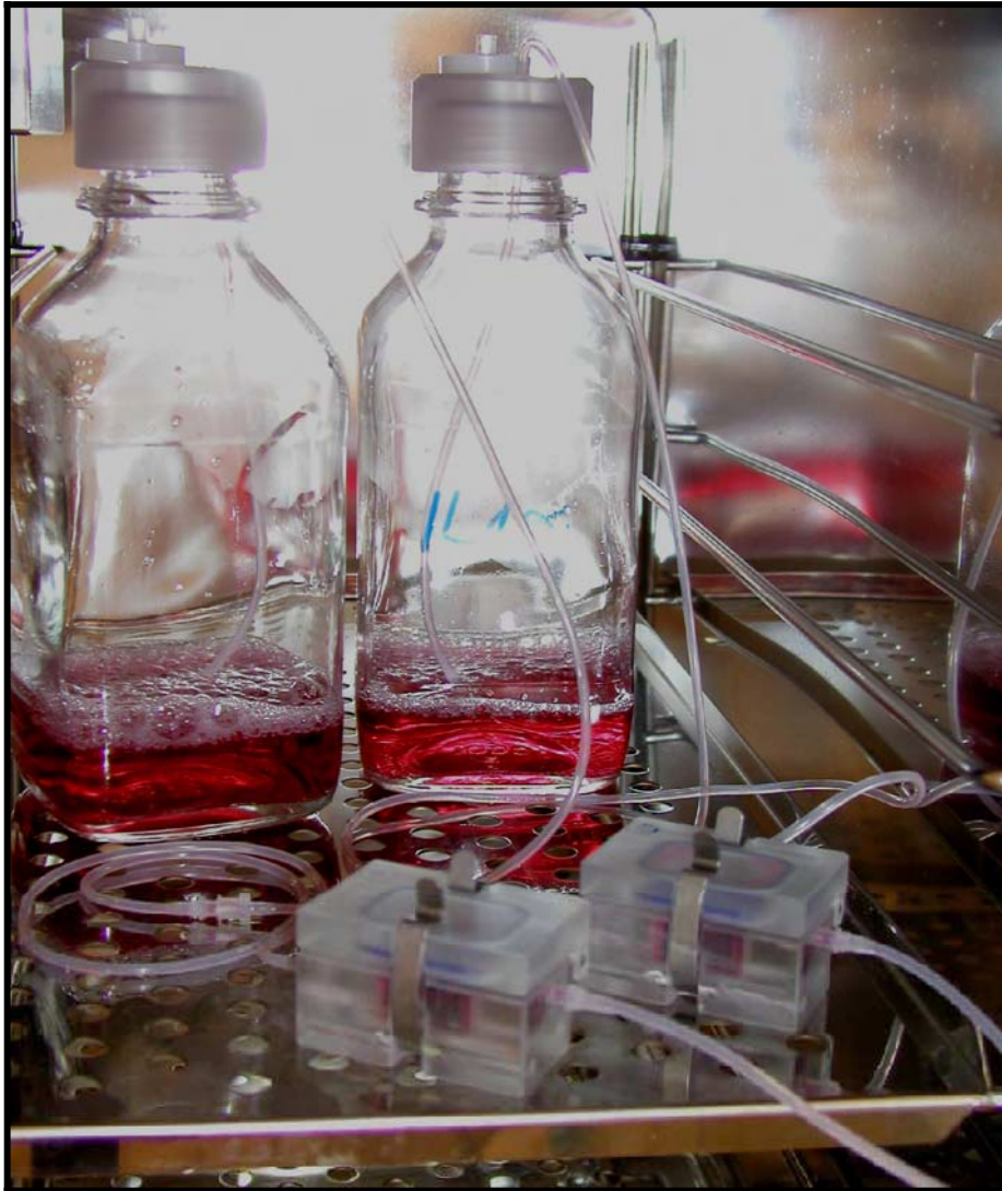
Abb. 18 Minuthkammern mit angeschlossenem Tubing System und Medienflaschen im Brutschrank
