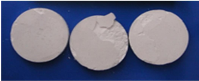
Abbildung 35 Photographische Aufnahme des Presslings der Probe 3A mit 2 Schichten, \text{Al}_2\text{O}_3 und \text{ZrO}_2 mit Zucker, vor dem Sintern
