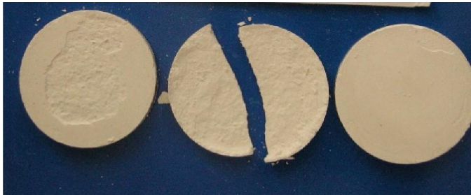
Abbildung 33 Fotografische Aufnahmen des Presslings der Probe 10 bestehend aus 2 Schichten, \text{ZrO}_2 und \text{Al}_2\text{O}_3 mit Zucker, vor dem Sintern
