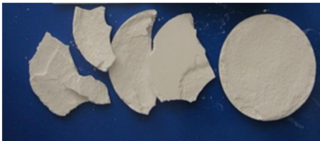
Abbildung 28 Fotografische Aufnahmen des Presslings der Probe 12 mit 6 Schichten vor dem Sintern, Pressdauer 4 Minuten
