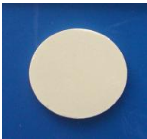
Abbildung 25 Fotografische-Aufnahme des Presslings der Probe 4 (10% Al 2 O 3 ) vor dem Sintern ohne Schichten; Pressdauer 2 Minuten
