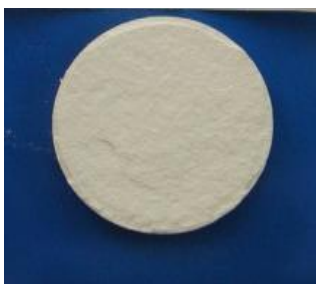
Abbildung 26 Fotografische Aufnahme eines Presslings der Probe 8 (ohne Schichten; 30% Al 2 O 3 ) vor dem Sintern, Pressdauer 4 Minuten
