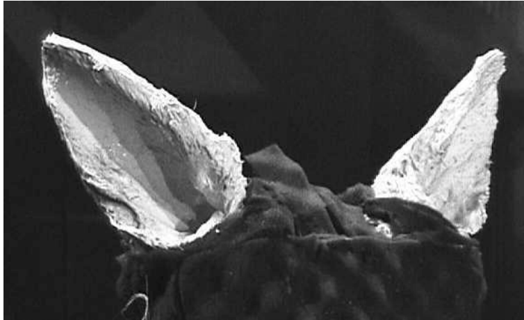
Abb. 3-5: rechtes und linkes Außenohrmodell von Tier 2 in der seitwärts gerichteten Ohrposition (Anordnung der beiden Modelle wie im Versuchsaufbau)
