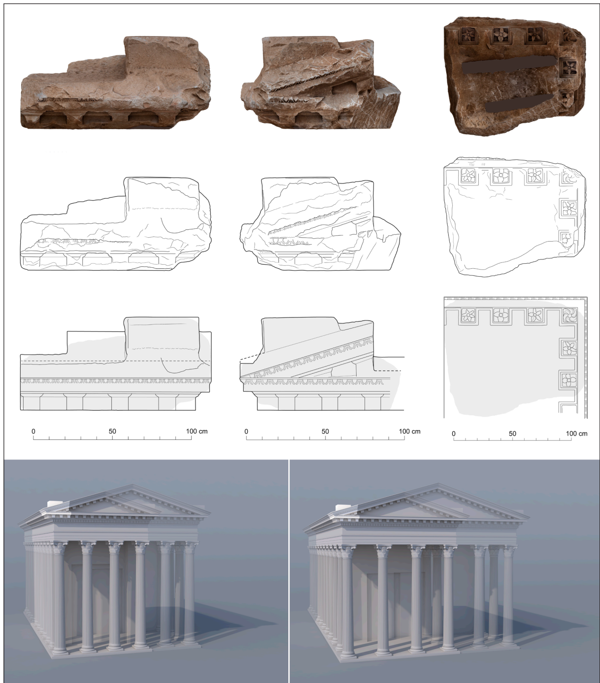
Abb. A4.9 Umland, Fundstelle 2019/07 bei Bozköy. 3D-Modell, Zeichnung und Rekonstruktion des Giebelgeisons (links, vorne, unten) sowie hypothetische Rekonstruktion der pyknostylen oder systylen Fassade anhand des Proportionssystems des Giebelgeisons
