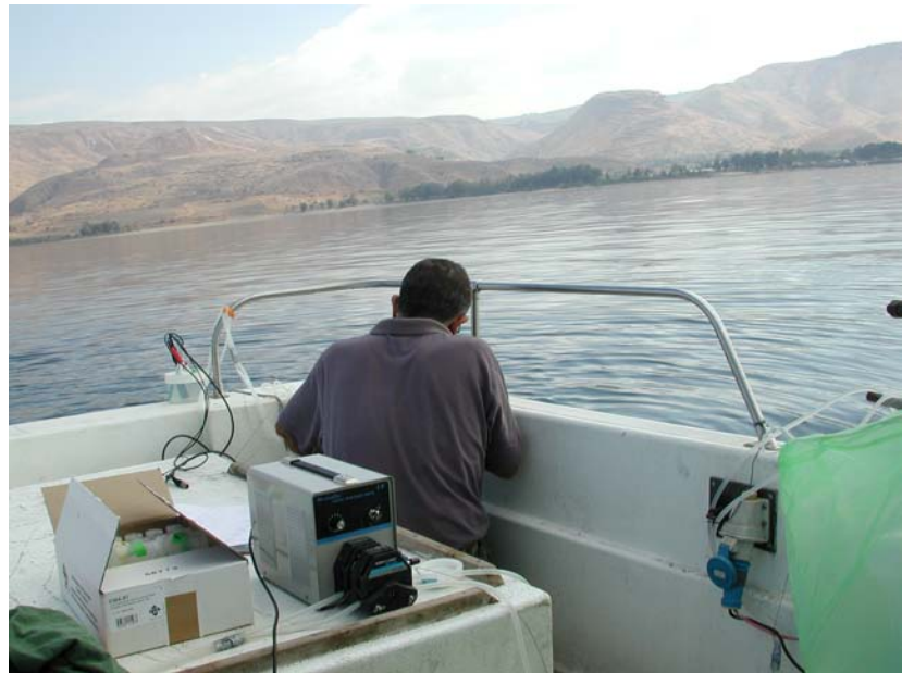
Abb. 2-4: Probenahme auf dem See Genezareth mittels 2-Kanal Schlauchpumpe.
