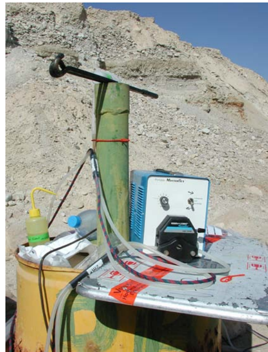
Abb. 2-5: Probenahme an einer Grundwassermessstelle.
