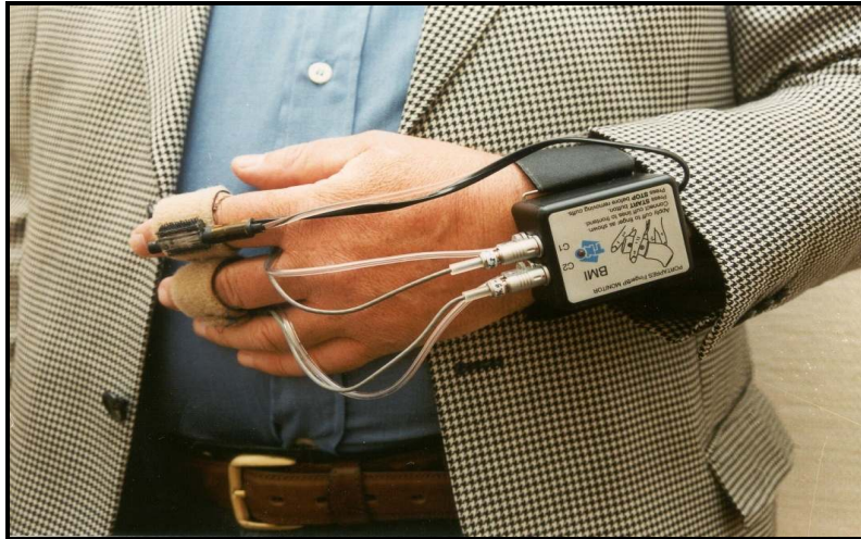
Abb. 2: Portapres-System für die nichtinvasive fingerarterielle Blutdruckmessung Fotografie aus dem Schlafmedizinischen Zentrum der Charité. Am Handgelenk befindet sich eine Einheit, die den Druck der Fingermanschetten über die druckzuführenden Schläuche kontrolliert. Der Sensor für die Höhenausgleichsmessung befindet sich an der Fingermanschette des Zeigefingers.
