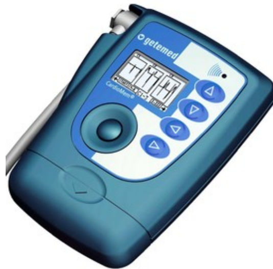
Abbildung 10: Beispiel eines LZ-EKG-Rekorders von Getemed Typ CardioMem CM 3000-12 BT [42]
