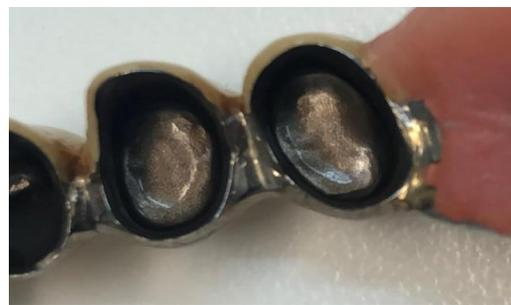
Abbildung 13: Korrosion durch Materialmix
