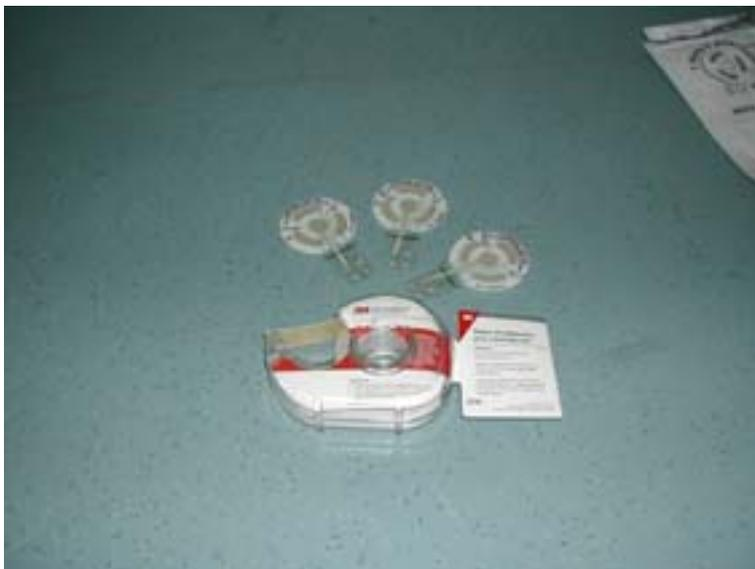
Abb. 3: Multipolare Elektroden (Hi-Res™) und Hautpräparationsmittel zur Impedanzminderung für die TWA-Messung
