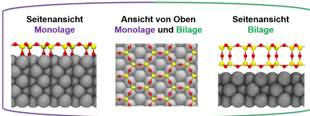
Abbildung 10 Die linke und rechte Seite stellen die Seitenansicht der Monolage (linke Seite) und der Bilage (rechte Seite) des Siliziumdioxidfilms auf dem Rutheniumsubstrat dar. Das Bild in der Mitte repräsentiert die Ansicht von oben auf die Mono- und Bilage. In der hier gezeigten Abbildung adaptiert von Ref. 124 wird die Sauerstoffbedeckung zwischen Siliziumdioxidfilm und Substrat vernachlässigt.
