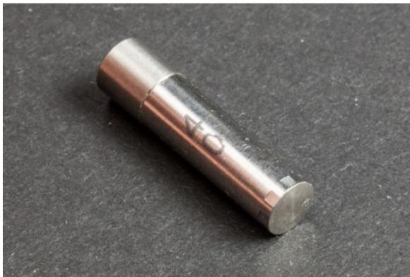
Abb. 1: SmCo-Magnet-Halbzeug des Typs „X-Line“
