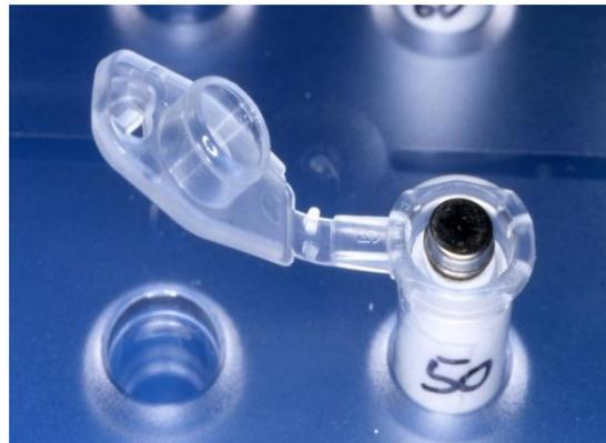
Abb. 5: offenes Eppendorf-Reaktionsgefäß mit Prüf-Magnet
