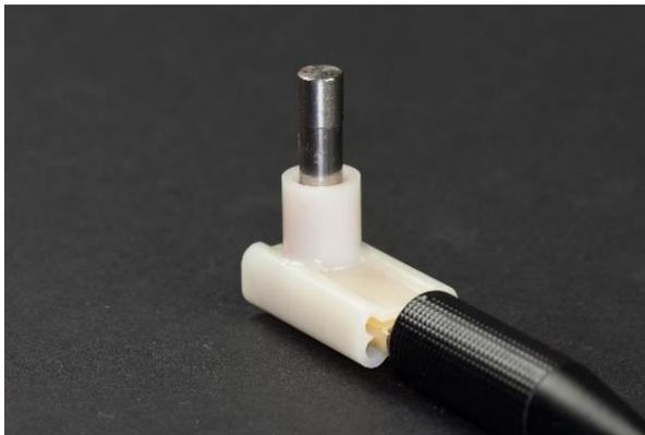
Abb. 4: Positionierungsschlüssel aus PMMA mit eingesetztem Magnet-Halbzeug
