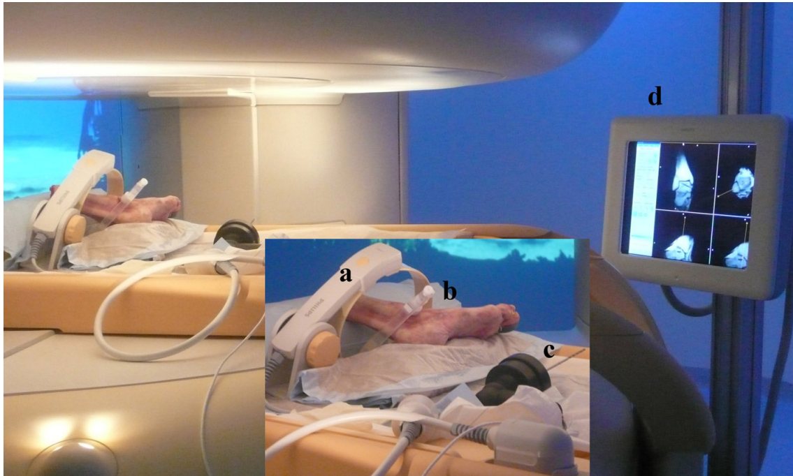
Abbildung 10: Dargestellt ist der Versuchsaufbau einer Talusbohrung im offenen MRT (Panorama HFO; Philips Healthcare, Eindhoven, Niederlande) am Campus Mitte der Charité-Universitätsmedizin Berlin. Für die Bohrversuche wurden die humanen Präparate auf Sandsäcken stabil gelagert und fixiert. Die Ringspule (Multipurpose L Coil; Philips Healthcare, Eindhoven, Niederlande) (a) wurde senkrecht zum Hauptmagnetfeld B_0 und ringartig um das Versuchsobjekt so platziert, dass eine ungehinderte Ausrichtung des Zielinstrumentes (b) am Kadaver ermöglicht wurde. Die Bohrungen wurden nach Festlegung der Bohrrichtung durch Ausrichtung des Zielinstrumentes mit einer piezoelektrisch-betriebenen Bohrmaschine (INVIVO, Schwerin, Deutschland) (c) unter direkter visueller Kontrolle am interaktiven Monitor (d) durchgeführt.
