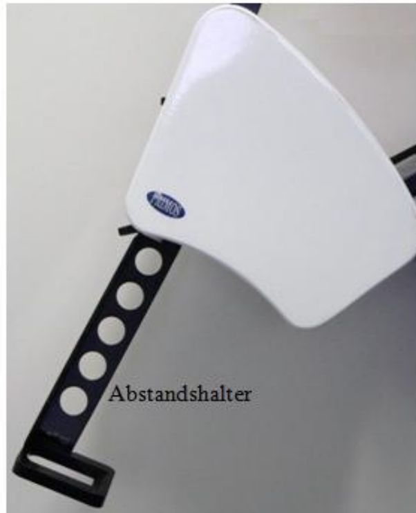
Abbildung 8: PRIMOS contact Messgerät mit Abstandshalter [65]
