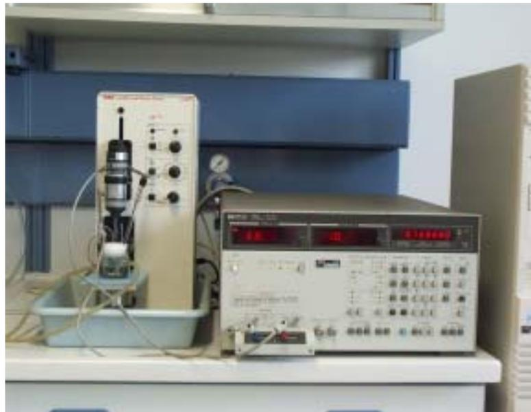
**Abb. 22** Impedanzmesseinrichtung der Firma Hewlett-Packard (Modell 4192A LF) und BAS Elektrodenstand
