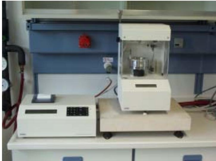
**Abb. 27** Prozessor Tensiometer Krüss K-12
