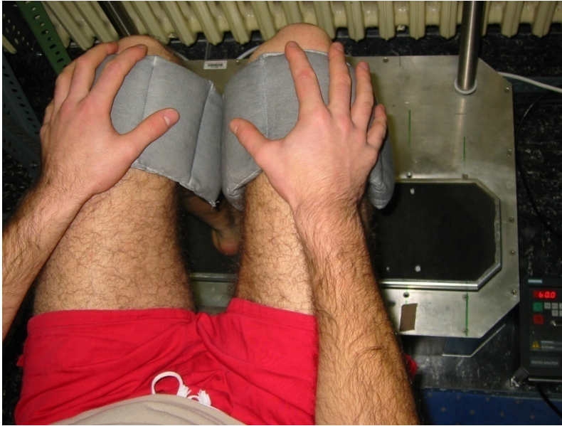
Abbildung 3: Sitzposition des Probanden an der Vibrationsplattform und Fixation mit Bleigewichten
