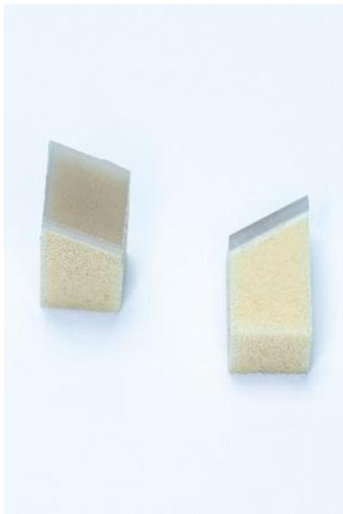
Abbildung 3: CAD/CAM gefräste Sawbones-Knochenblöcke
