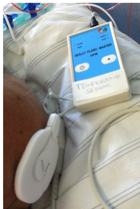
Abbildung 4: Der Doppelsensor im klinischen Einsatz (l.u.) zusammen mit dem Aufzeichnungsgerät (r.o.) (eigene Abbildung)
