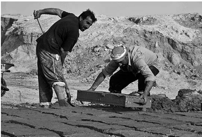
Abb. 259: Danach kann die Form sofort abgezogen und für die nächsten Ziegel verwendet werden. Im Anschluss daran...
