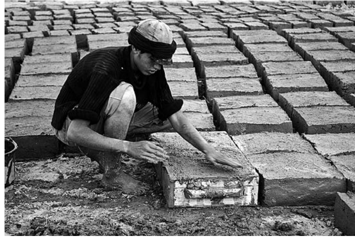
Abb. 258: ...die nach kurzer Einsumpfzeit in Holzformen gefüllt, verdichtet und an der Oberfläche glatt gestrichen wird.
