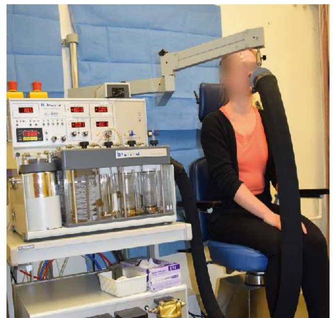
► Abb. 2 Versuchsaufbau Olfaktometer. Gesunde Probandin exemplarisch bei der Messung. links im Bild das Olfaktometer. Die Duftstoffe werden über den Rienschlauch in die Nasenöffnung der Probandin appliziert.
