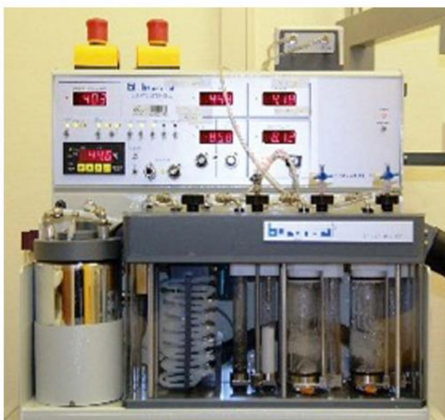
► Abb. 1 verwendetes Olfaktometer (OM 2/S Olfaktometer, Burg-hart Messtechnik GmbH, Wedel, Deutschland).
