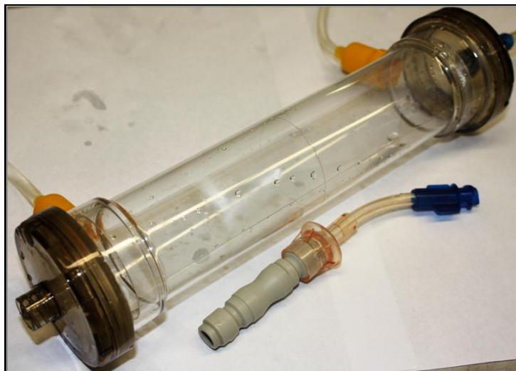
Abbildung 20: Fotografische Darstellung des leeren Dialysatorgehäuses, das als Bypassapparatur verwendet wurde.
