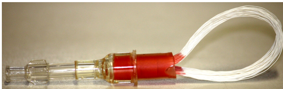
Abbildung 16: Foto eines verwendeten Mini-Dialysemoduls: Das Kunststoffgehäuse ist mit einem Spritzenaufsatz versehen, die Dialysefaser sind in einen Silikonstopfen eingegossen.
