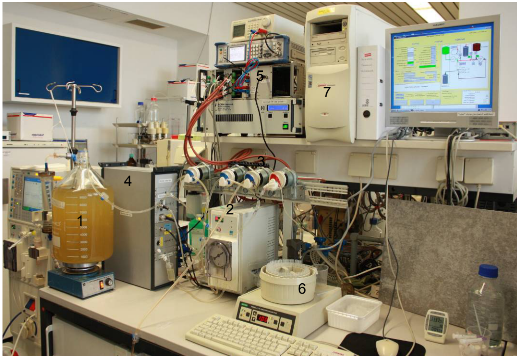
Abbildung 43: Fotografische Darstellung des entwickelten Testsystems. (1) Eine Albuminlösung wird durch (2) eine Schlauchpumpe und (3) ein Ventilsystem über ein Schlauchsystem in (4) das Abschirmgehäuse mit darin befindlichem Hämodialysator gefördert. (5) Ein HF-Signalgenerator erzeugt die elektrischen oder magnetischen HF-Felder. Die Albuminproben werden mittels (6) Fraktionssammler aufbewahrt. (7) Ein Computer dient zur Steuerung des Systems
