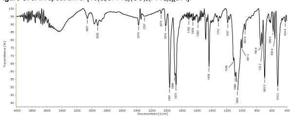
Figure S73. IR spectrum of  $[Tc(S_2CPPh_3)(CO)_2(PPh_3)_2][BF_4]$ .
