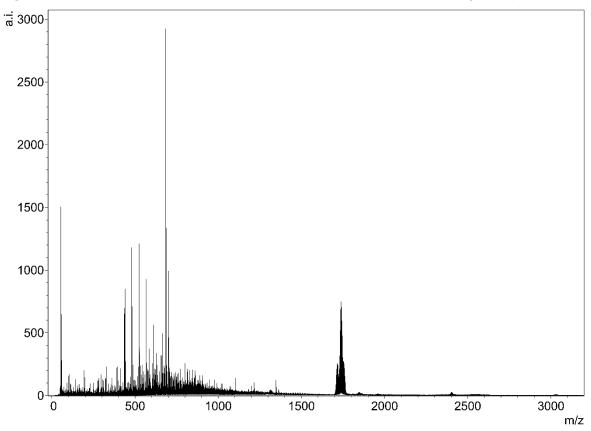
ESI<sup>+</sup> MS (m/z): 1718.5037 ([(Pd(L<sup>Te</sup>))<sub>4</sub>+H]<sup>+</sup> Calcd 1718.5191, 9%), 1740.4933 ([Pd(L<sup>Te</sup>))<sub>4</sub>+Na]<sup>+</sup> Calcd 1740.5011, 26%), 1756.4750 (Pd(L<sup>Te</sup>))<sub>4</sub>+K]<sup>+</sup> Calcd 1756.4749, 9%).
