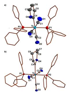
**Figure 4.** Solid-state structures of a)  $[Tc{=}C(CH_2)_3O{-}(CO)_3(PPh_3)_2]^+$  (6) (Tc-C1 1.964(3), Tc-C2 1.982(3), Tc-C3 1.997(3), Tc-C4 2.098(3), C4-O4 1.300(4), C4-C5 1.495(4) Å) and b)  $[Tc{=}C(CH_2)_4O{(CO)_3(PPh_3)_2}^+$  (7) Tc-C1 1.977(3), Tc-C2 1.983(3), Tc-C3 1.992(3), Tc-C4 2.117(3), C4-O4 1.302(4), C4-C5 1.484(5) Å).
