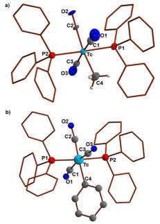
**Figure 1**. a) Solid-state structure of [Tc(CH<sub>3</sub>)(CO)<sub>3</sub>(PPh<sub>3</sub>)<sub>2</sub>] (**3**) (Tc-C1 2.003(3), Tc-C2 1.940(6), Tc-C3 1.988(4), Tc-C4 2.289(8) Å) and b) [Tc(Ph)(CO)<sub>3</sub>(PPh<sub>3</sub>)<sub>2</sub>] (**4**).
