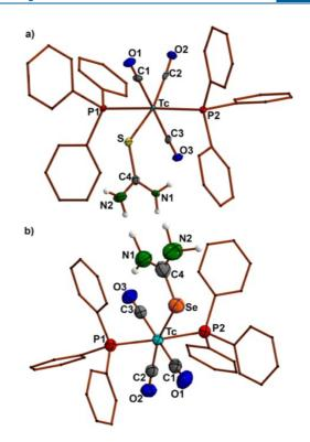
Figure 16. Structures of the complex cations of a)  $[Tc(tu)(CO)_3-(PPh_3)_2](BF_4)$  (23)  $(Tc-C1\ 2.005(5)\ Å,\ Tc-C2\ 1.915(5)\ Å,\ Tc-C3\ 1.981(5)\ Å,\ Tc-S\ 2.529(1)\ Å;\ C1-Tc-S\ 77.3(2)^\circ,\ C3-Tc-Se\ 99.9(2)^\circ)$  and b)  $[Tc(seu)(CO)_3(PPh_3)_2](BF_4)$  (24)  $(Tc-C1\ 1.992(8)\ Å,\ Tc-C2\ 1.903(9)\ Å,\ Tc-C3\ 1.975(8)\ Å,\ Tc-Se\ 2.654(1)\ Å;\ C1-Tc-Se\ 75.7(3)^\circ,\ C3-Tc-Se\ 102.0(3)^\circ).$
