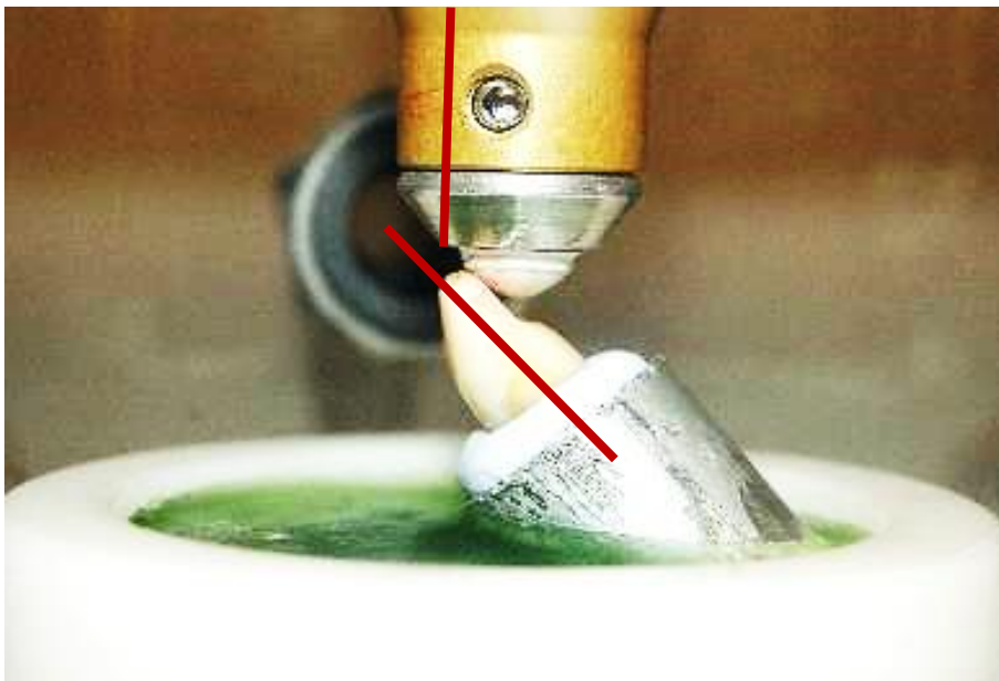
Abbildung 9 eD : Die Abbildung zeigt einen beispielhaft in Silaplast Futur (Detax) eingebetteten Zahn im Kausimulator. Die Steatitkugel trifft in einem Winkel von 45° zentral auf die palatinale Fläche des Zahnes.
