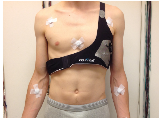
Abbildung 9: Schultergürtel und iButtons am Probanden
