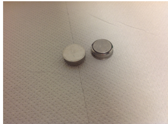
Abbildung 6: iButtons®; rechts ist die messende Seite zu sehen
