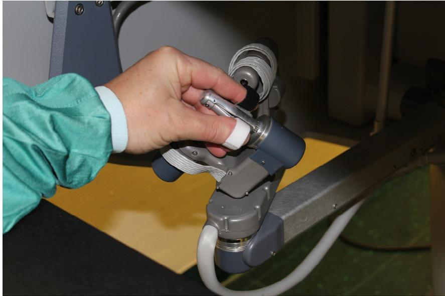
**Bild 2** zeigt einen der zwei Handcontroller. Über diese Griffe der Hauptkomponente Steuerungseinheit erfolgt eine tremorfreie Übertragung seitens des Operators auf die Roboterarme. Das System vollzieht keine automatisierten oder selbständigen Abläufe. Analog zu den Handbewegungen des Operators vollziehen die Arme skalierte und gefilterte Bewegungen.
