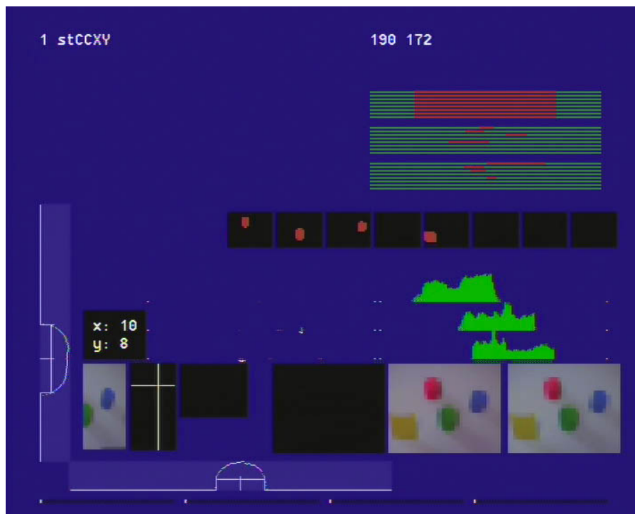
Abbildung 15: Typisches Fenster der Behavior Design Environment (BDE) . In diesem Beispiel werden vier farbige Objekte im Kamerabild erkannt und deren Positionen ermittelt. Unter Berücksichtigung der Auflösung der Videoausgabe von 720 x 576 Pixeln sind beliebige Darstellungen realisierbar.
