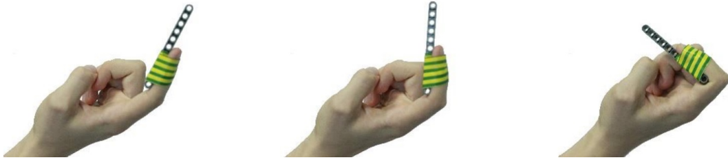
Abbildung 25: Verlängerung des menschlichen Zeigefingers mit einem Kunststoffstab für Experimente zur taktilen Wahrnehmung über die mechanische Kopplung zwischen Finger und Stab. Entnommen aus [MM15].
