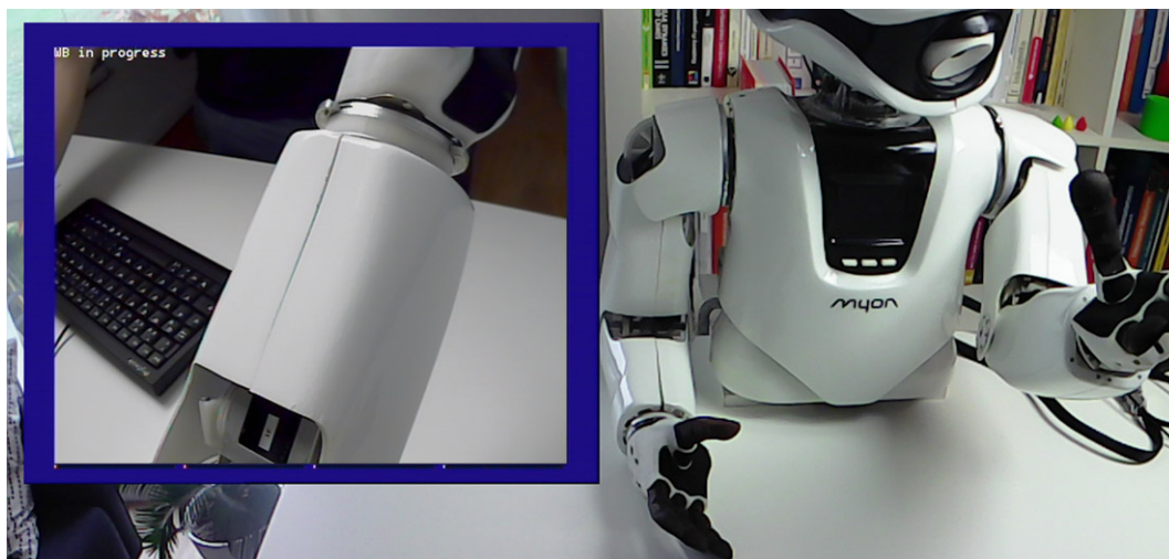
Abbildung 28: Weißabgleich der Kamera an der Verschalung des linken Arms. Der Ausschnitt oben links zeigt das Bild der Kamera im Auge. Die Arminnenseite ist auf Grund des Schattens durch die hier gegebene Belichtungssituation nicht geeignet für einen Weißabgleich.
