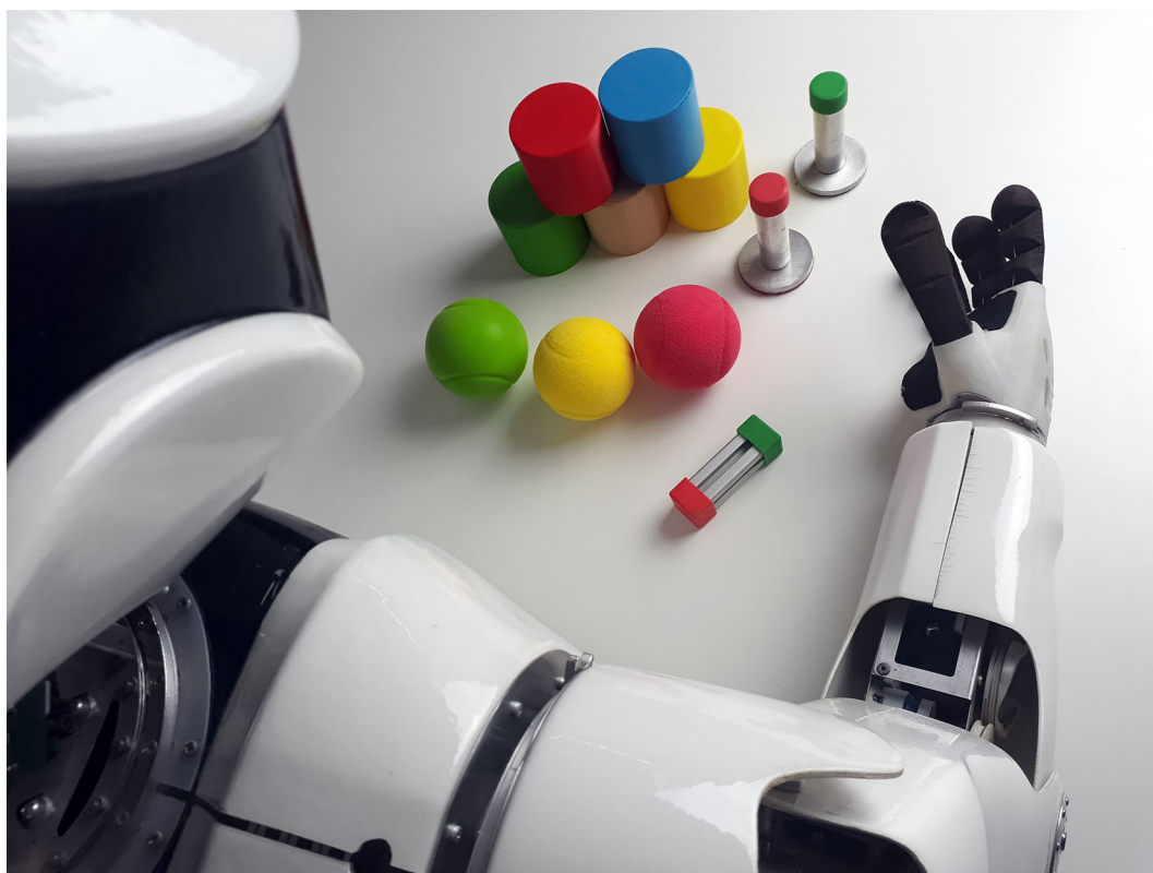
Abbildung 27: Blick über die Schulter des humanoiden Roboters. Auf dem Tisch liegen Objekte mit unterschiedlichen Farben und Formen. Da der Roboter keine eigene Lichtquelle besitzt, steht zur Objekterkennung nur die gegebene Beleuchtung zur Verfügung – Schattenbildung und Verdeckung sind ein typisches Problem.
