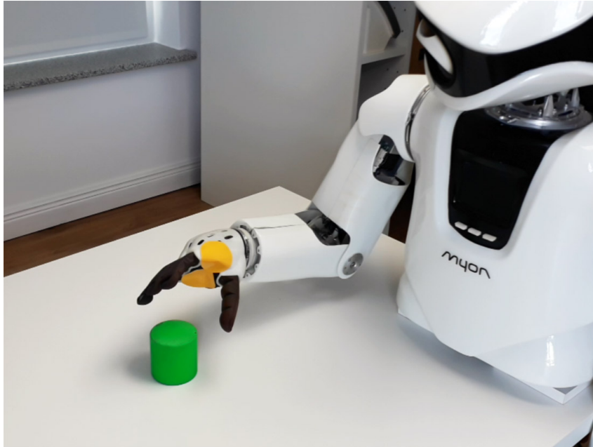
Abbildung 74: Greifen eines Objekts von oben mittels Blickheuristik und Abstandsinformation durch den Funktionswert der Funktion Q der Tisch-Quadrik.
