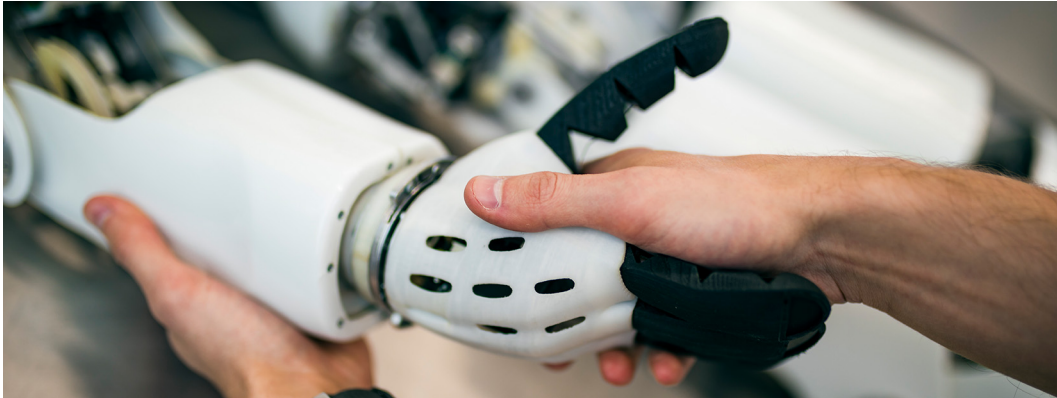
Abbildung 9: Zum Vergleich geben sich ein Erwachsener und Myon die Hand. Der Vier-Finger-Greifer ist in seinen Abmessungen vergleichbar mit der Hand eines Jugendlichen und kann damit ähnlich große Objekte greifen wie ein Erwachsener. (Quelle: photothek/Xander Heidl)
