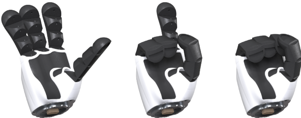
Abbildung 10: Darstellung der Zustände des Vier-Finger-Greifers: (links) offene Hand, (mitte) Zeigefinger gestreckt (Zeigen), (rechts) geschlossene Hand (Greifen/Faust). Von der offenen Hand zu den beiden Endpositionen sind beliebige Zwischenpositionen möglich. Entnommen aus [Sie15].
