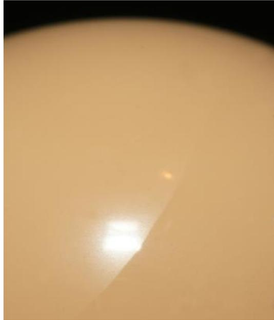
**Abbildung 23:** aufgeraute Oberfläche einer CoC-Gleitpaarung bei klinisch nachweisbarem Quietschen, das zugehörige Keramikinlay wies keine Auffälligkeiten auf; die Ursache der aufgerauten Oberfläche ist nicht bekannt.
